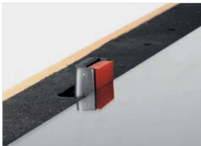
I piedini automatici fungono da appoggio lastra durante il basculamento del piano e, se necessario, come allineatori meccanici della lastra.
