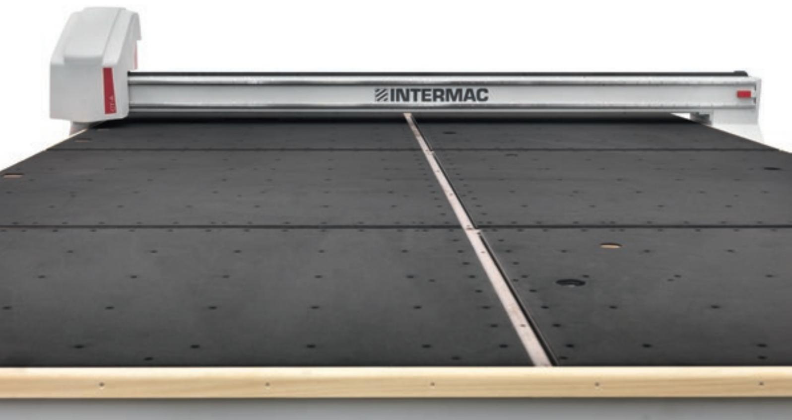
Il basamento della macchina è composto da una struttura rigida e rettificata su cui vengono applicati pannelli di legno rettificati che assicurano la massima planarità dell'area di lavoro, condizione necessaria per una riuscita ottimale dell'incisione e del troncaggio del vetro.
